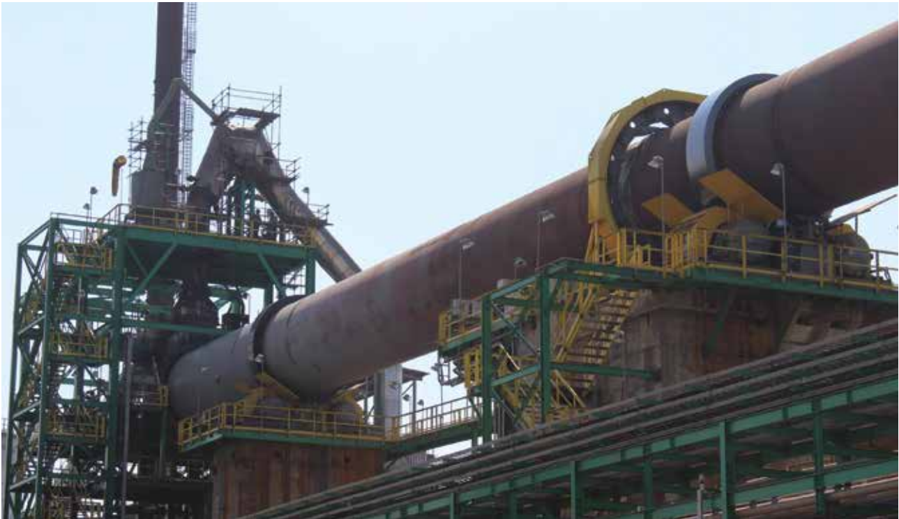
Drehrohröfen am Bergwerk Maracás zur Vanadium-Aufbereitung (Foto: DERA 2015)
